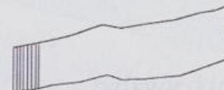
*faciès fibreux (joints et fissures)*
