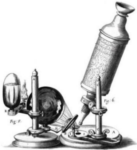
► Représentation du microscope fabriqué par Robert Hooke.
